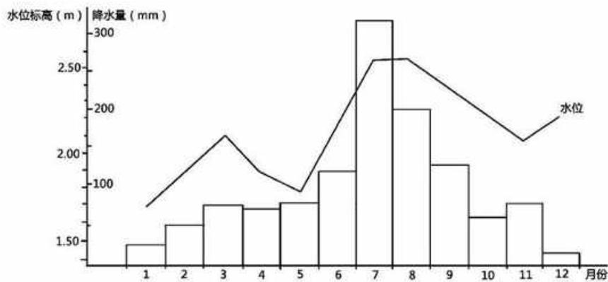
图 5.2-3 潜水位与降水量变化曲线图
