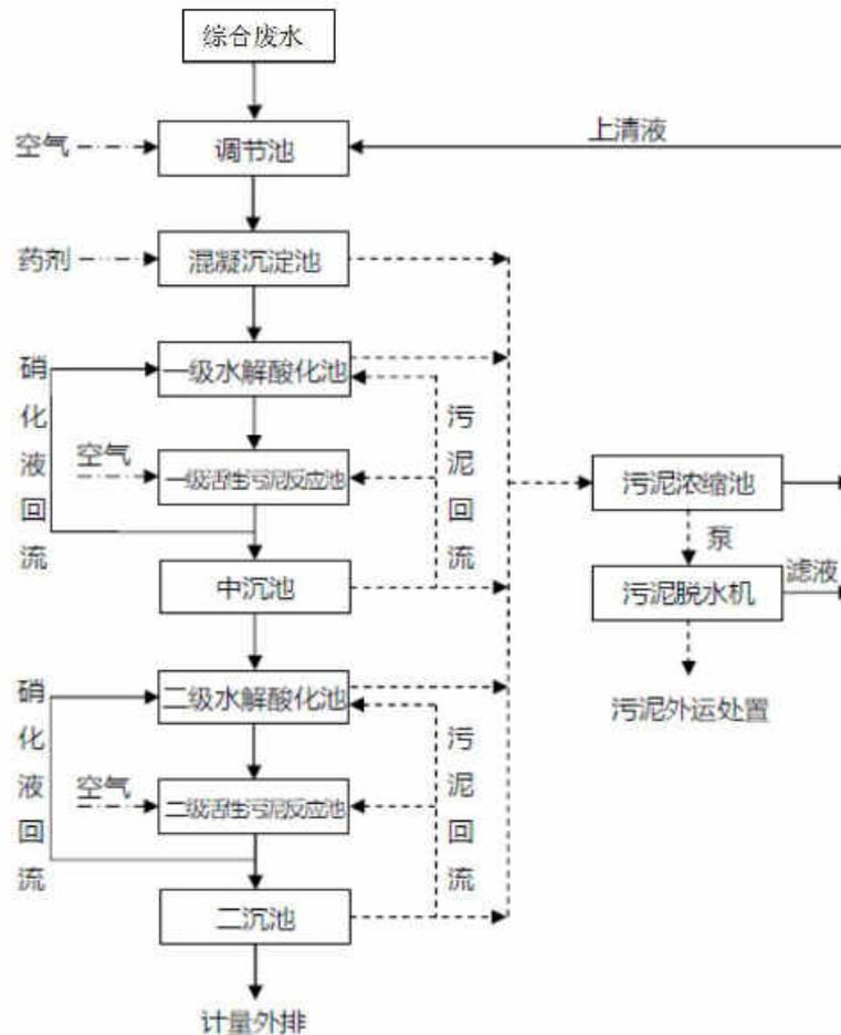
图4.3-4 废水收集流向、处理流程图
