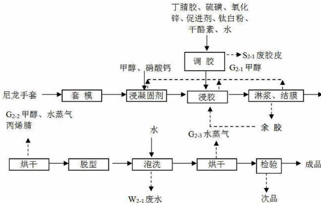
图 4.3-2 生产工艺流程及产物环节图
